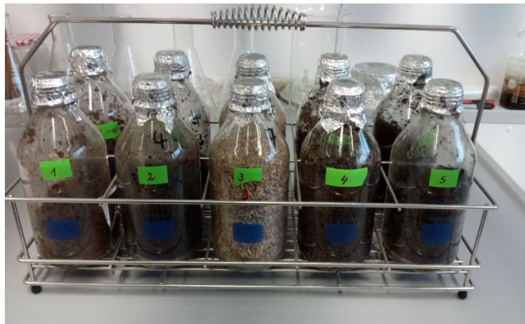
Abbildung 3.4.2: Dotierte Substrate (Originaldotierung sowie 1:10 Verdünnung) im Abbautest
