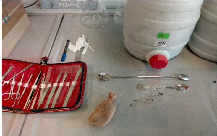
Abbildung 3.4.1: Präparation der dotierten Substrate („Säckchen“) im Migrationstest
